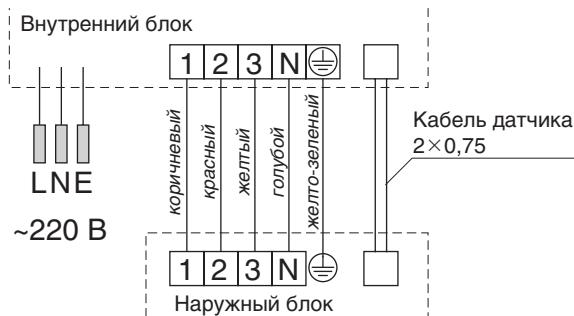
9.1.2 Межблочные электрические схемы для моделей производительностью 24000 Btu/h..
