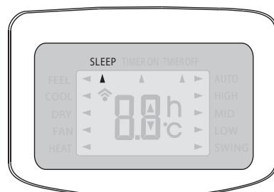
В режиме охлаждения после первого часа работы заданная температура автоматически поднимается на 1 °C.
